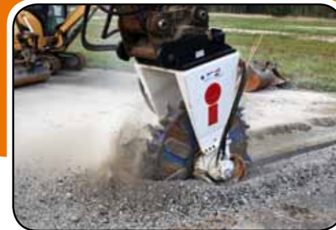
Die Fräsen eignen sich für Einsätze in Asphalt, Beton und Fels bis zu einer einachsigen Druckfestigkeit von 80 MPa (mittelharter Kalkstein) und sind bis 30 Meter unter Wasser einsetzbar.
